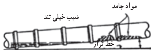
شکل ۱۱-۳ الف - نتیجه‌ی شیب زیاد لوله‌ی افقی فاضلاب
