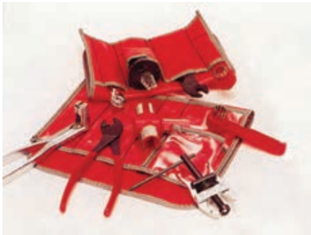
شکل ۸۰-۱- کیف ابزار سرویس باتری
