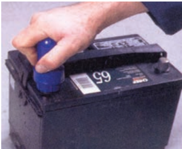
شکل ۸۹-۱ - نحوه‌ی استفاده از ابزار مخصوص باتری
