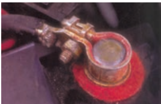
شکل ۱-۹۷- گریس زدن بست قطب‌ها
