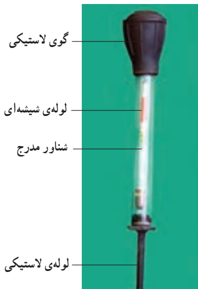
شکل ۱-۱۴- دو نوع هیدرومتر یا چگالی سنج
