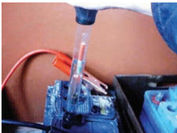
شکل ۱-۶۲- کنترل غلظت الکترولیت
