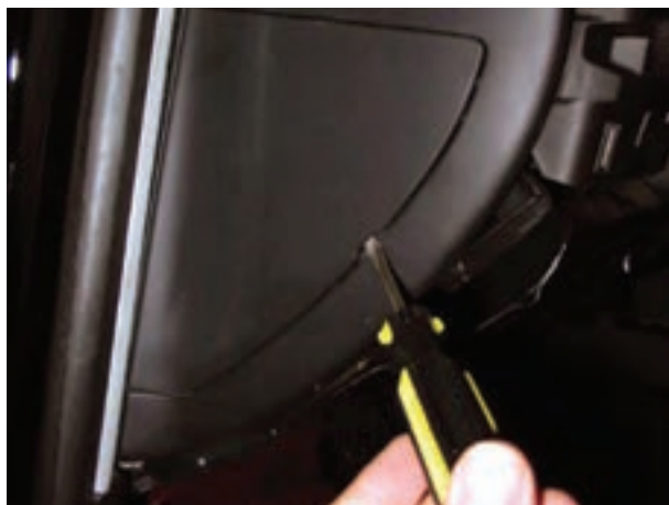
شکل ۱۱۸-۱- آزاد کردن خار پوشش محفظه‌ی جعبه‌ی فیوز
