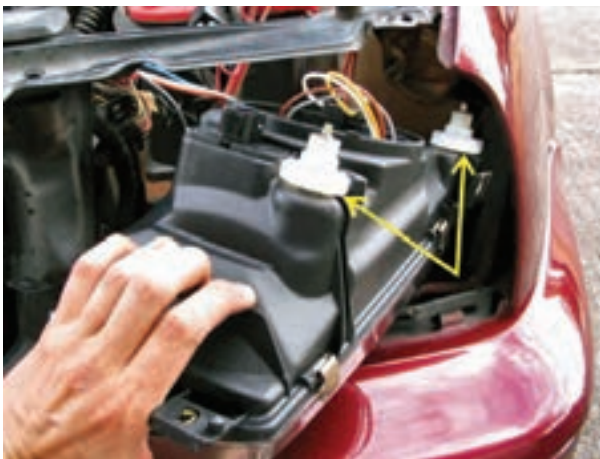
شکل ۱-۱۵۶- اهرم تنظیم کاسه چراغ یک نوع خودرو
