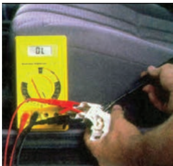
شکل ۹۸-۱- آزمایش حالت استپ موقت دسته ی راهنما
