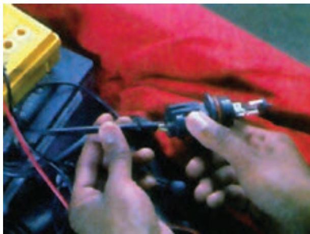
شکل ۱۴۲-۱- آزمایش لامپ چراغ‌های بزرگ جلو
