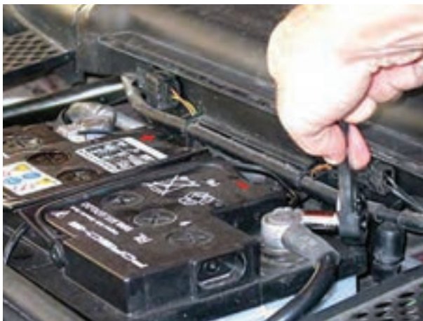
شکل ۱۸-۵- باز کردن کابل اتصال بدنه‌ی باتری
