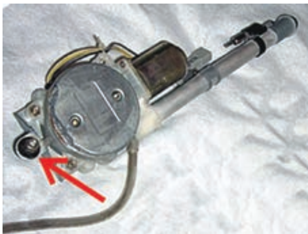
شکل ۵-۲۲- آنتن الکتریکی پس از پیاده کردن آن
