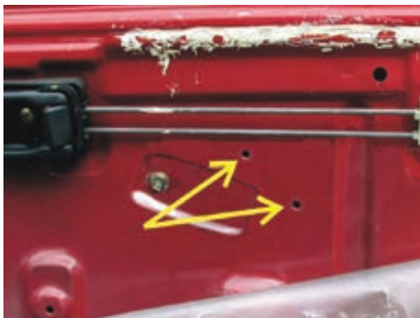
شکل ۲-۲۷ سوراخ کاری بدنه‌ی داخلی در خودرو
