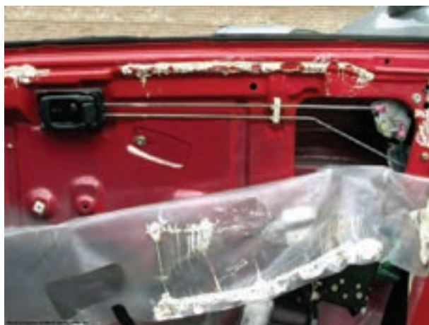
شکل ۲-۲۶- جدا کردن پلاستیک محافظ روی در
