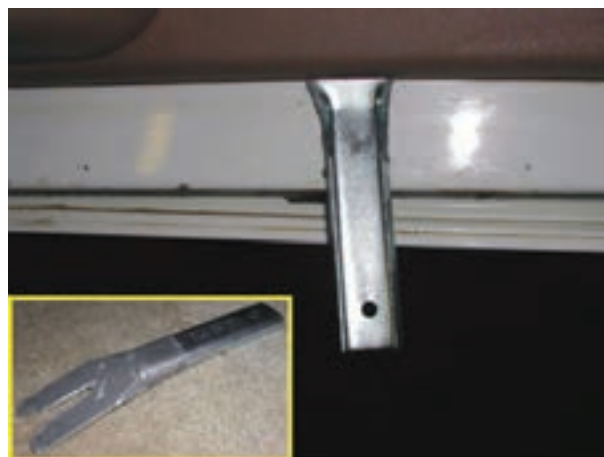
شکل ۲-۳۵- اهرم خاردرآر و نحوه‌ی استفاده از آن
