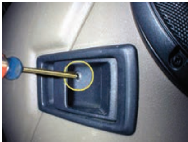
شکل ۳۶-۲- باز کردن قاب دستگیره‌ی قفل در
