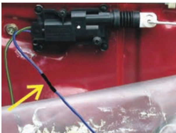
شکل ۲-۴۹- عایق کاری محل اتصال سیم‌ها به یکدیگر
