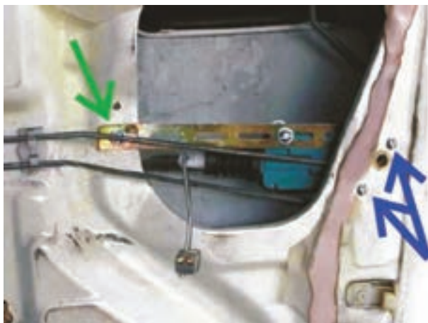
شکل ۳۹-۲- باز کردن پیچ‌های اتصال عملگر الکتریکی
