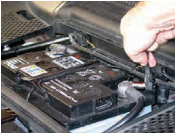
شکل ۲-۳۳- باز کردن اتصال بدنه‌ی باتری
