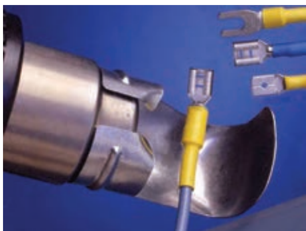
شکل ۶-۳۱- عایق کاری محل اتصال سیم و سرسیم
