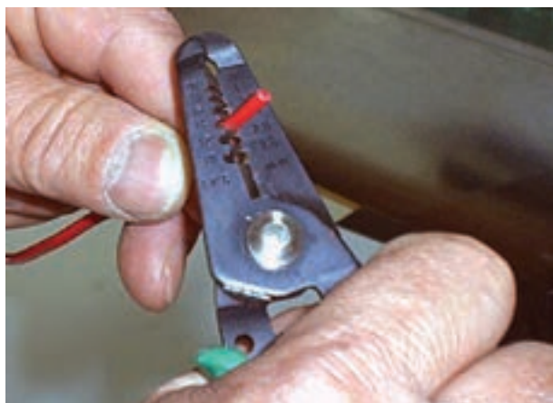
شکل ۶-۳۰- جدا کردن عایق سیم
