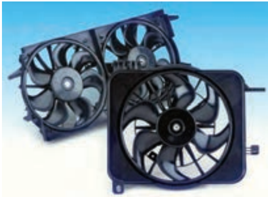
شکل ۶-۶ فن‌های الکتریکی مورد استفاده در خودروها
