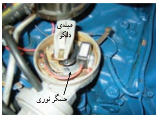
شکل ۱۴۵-۲- سه نمونه حسگر استفاده‌شده در سیستم جرقه‌زنی
