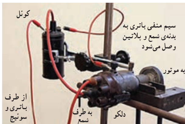
شکل ۱۴۴-۲- مدار شبیه‌سازی شده‌ی سیستم جرقه‌زنی
