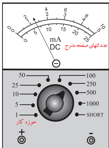
شکل ۱-۵۴- تمرین برای محاسبه جریان ولت متر آنالوگ
