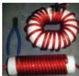
سلف پیچیده شده روی قرقره بدون هسته
