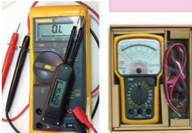
شکل ۴۱-۱- مولتی متر آنالوگ و دیجیتال
