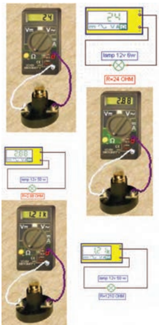
شکل ۸۹-۲- اندازه گیری مقاومت لامپ‌های روشنایی
