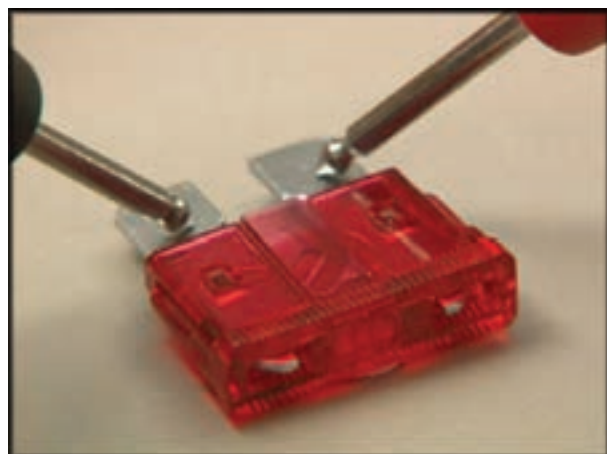
شکل ۱-۴۴ آزمایش فیوز توسط اهم‌متر
