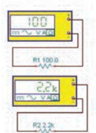
شکل ۹۰-۲- اندازه گیری مقاومت اهمی
