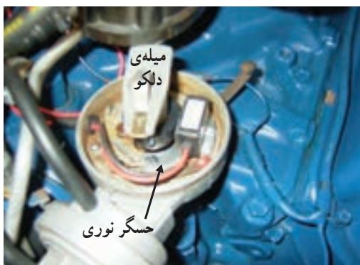
شکل ۱۴۵-۲- سه نمونه حسگر استفاده‌شده در سیستم جرقه‌زنی
