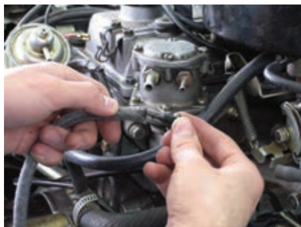
شکل ۱-۴۱ جدا کردن لوله‌ها
