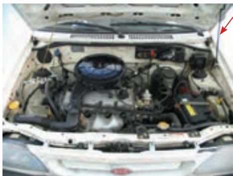
شکل ۱۱۹- ۱ نصب صحیح اهرم نگه‌دارنده درپوش موتور خودرو
