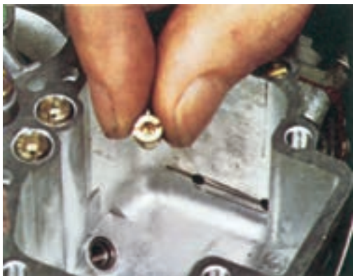
شکل ۱۱۸- ۱ باز کردن ژیکلور اصلی
