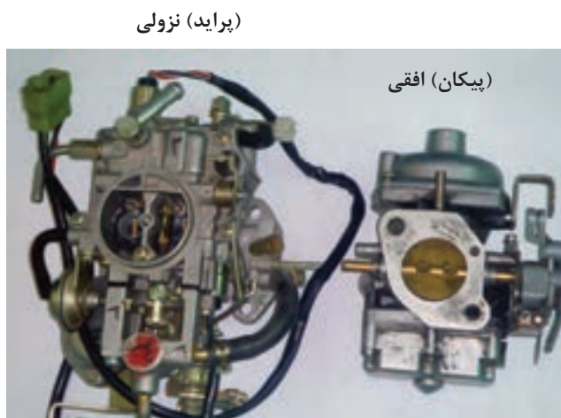
شکل ۱-۶۴ کاربراتورها از نظر حرکت سوخت (نزولی - افقی)
