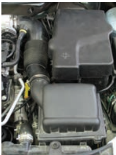
شکل ۵۱-۱ هواکش موتور انژکتوری
