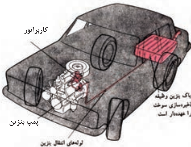
شکل ۱-۳۴ لوله‌های سوخت‌رسانی مخزن تا کاربراتور
