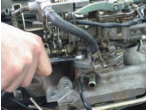
شکل ۱-۱۱۰ باز کردن پیچهای اتصال کاربراتور به موتور
