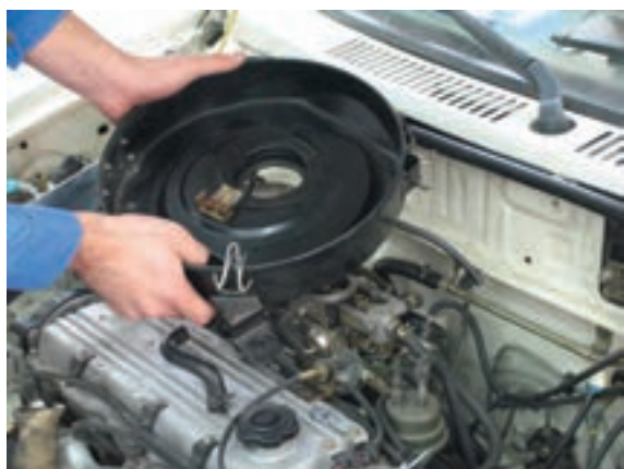
شکل ۱۱۴- ۱ پیاده کردن مجموعه هواکش
