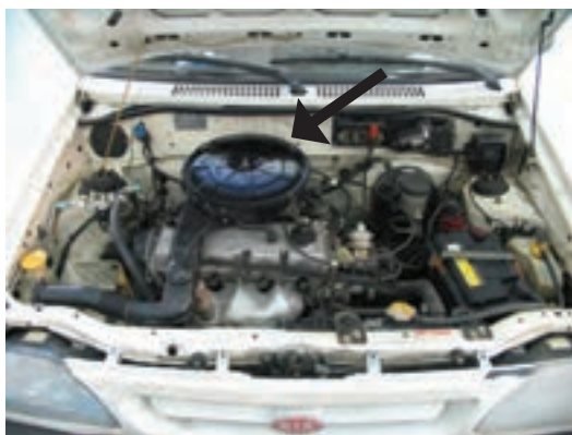
شکل ۵۰-۱ هواکش موتور کاربراتوری
