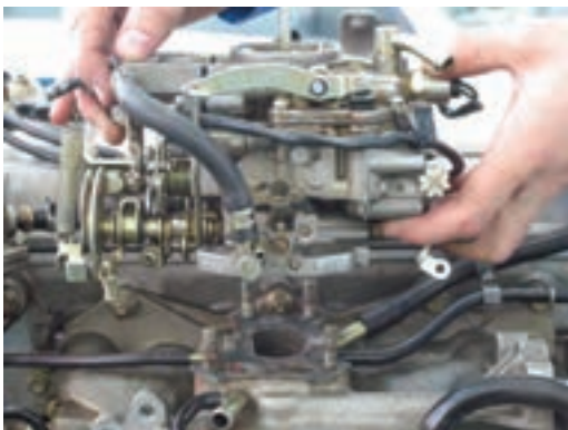
شکل ۱-۱۱۱ پیاده کردن کاربراتور
