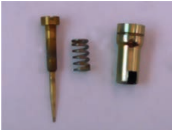
شکل ۱-۷۴ پیچ مخروطی و فنر تثبیت کننده سوخت دور آرام
