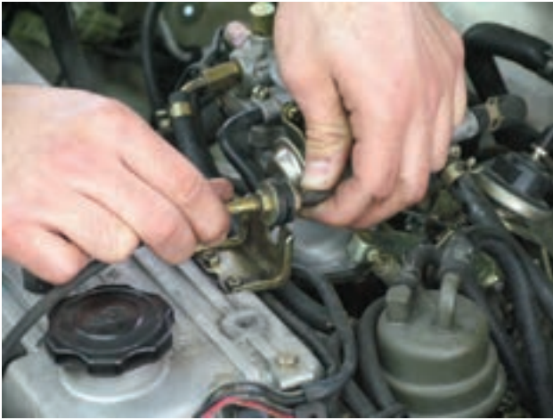
شکل ۱-۱۱۵ پیاده کردن کاربراتور
