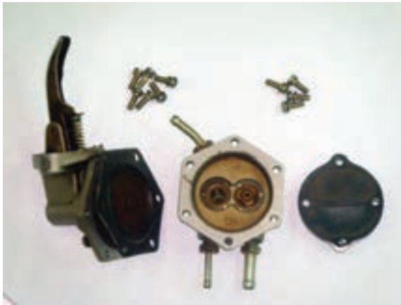
شکل ۱-۴۳ اجزای پمپ سوخت
