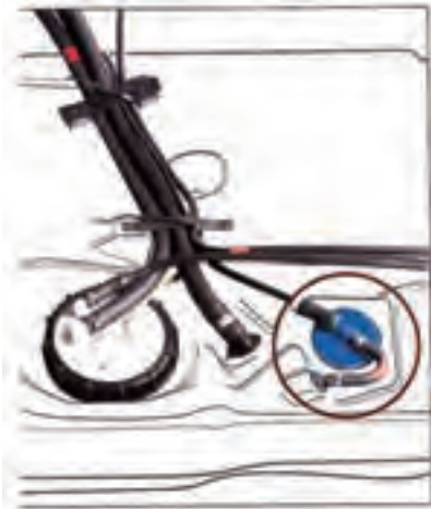
شکل (۱۶-۲) اتصالات سیستم سوخت رسانی
