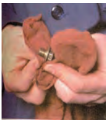
شکل (۲-۵۶) کنترل پیچ تخلیه ی روغن موتور
