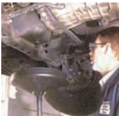
شکل (۲-۵۵) کنترل تخلیه شدن کامل روغن
