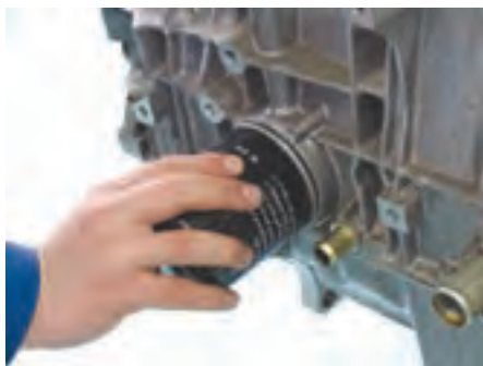
شکل (۲-۵۴) نصب و محکم کردن فیلتر
