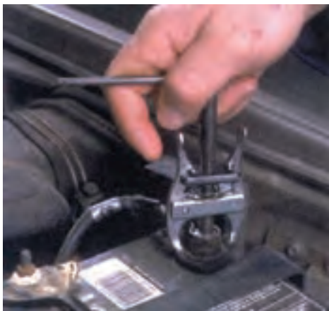
شکل (۲-۸۲) باز کردن بست باتری
