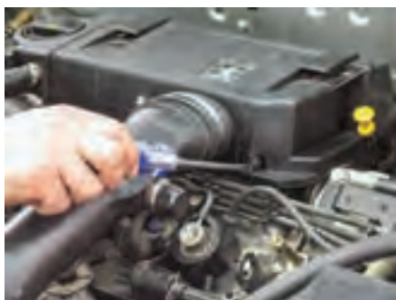
شکل (۲-۶۵) نصب در پوش محافظه فیلتر هوا
