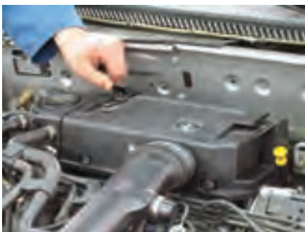
شکل (۲-۶۳) بازکردن در هواکش
