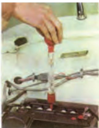
شکل (۲-۸۸) اندازه گیری غلظت مایع باتری
