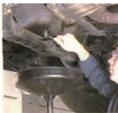
شکل (۲-۵۷) بستن پیچ تخلیه با گشتاور مناسب
