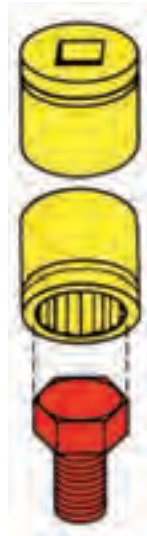
شکل (۱-۱۷) نحوه درگیری آچار بوکس
