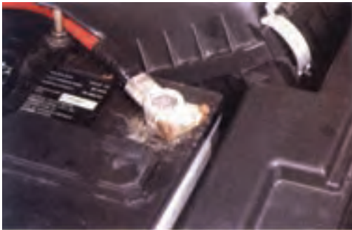
شکل (۲-۸۱) سولفاته شدن بست باتری
