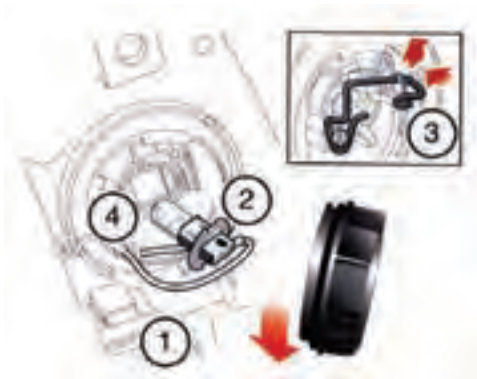
شکل (۲-۹۵) تعویض لامپ چراغ نور پایین
