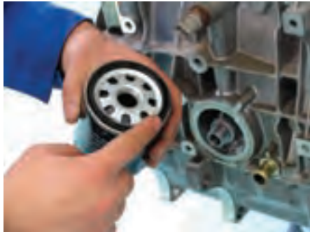
شکل (۲-۵۳) کنترل دندانه و واشر لاستیکی فیلتر
