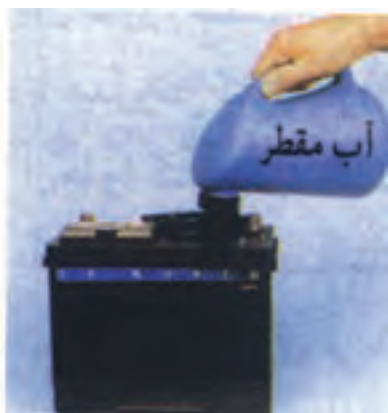
شکل (۲-۸۹) اضافه کردن مایع باتری
