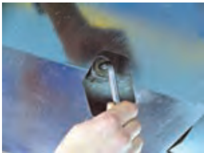
شکل (۲-۵۱) بازکردن پیچ تخلیه روغن موتور
