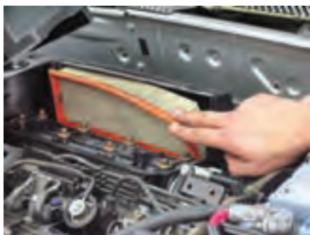
شکل (۲-۶۴) پیاده کردن فیلتر هوا
