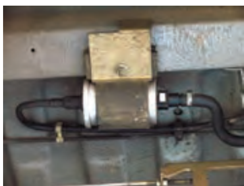
شکل (۲-۶۷) بست های دوطرف فیلتر سوخت
