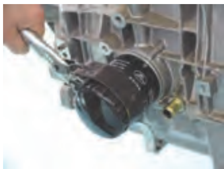
شکل (۴۸- ۲) بازکردن فیلتر با ابزار مخصوص
