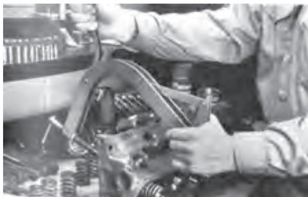
شکل (۱-۵۲) استفاده از فنر جمع کن سوپاپ
