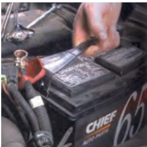
شکل (۲-۸۳) خارج کردن باتری
