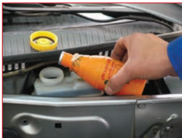
شکل ۱-۶۸- برکردن مخزن مایع ترمز تا حداکثر (MAX)
