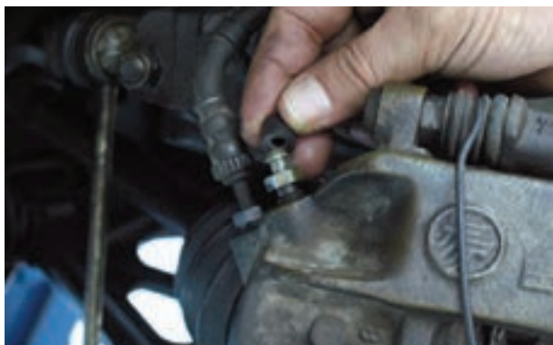
شکل ۱-۷۰- پاک کردن اطراف پیچ هواگیری
