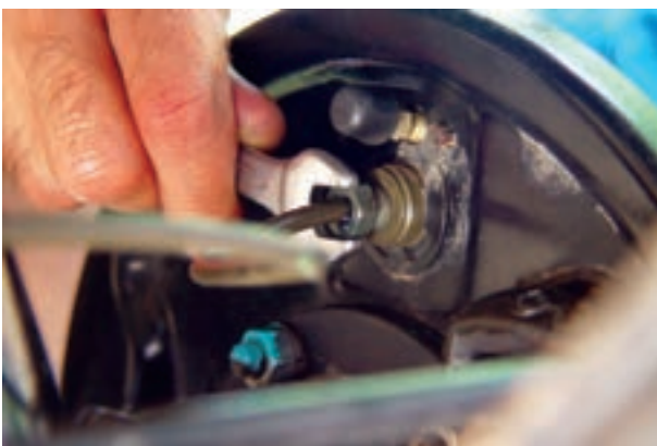
شکل ۱۰۵-۱- باز کردن مهره اتصال لوله ترمز
