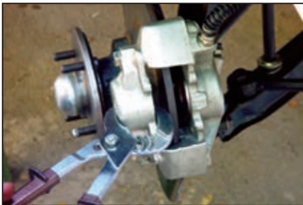
شکل ۱۱۴-۱- عقب راندن پیستون ترمز دیسکی
