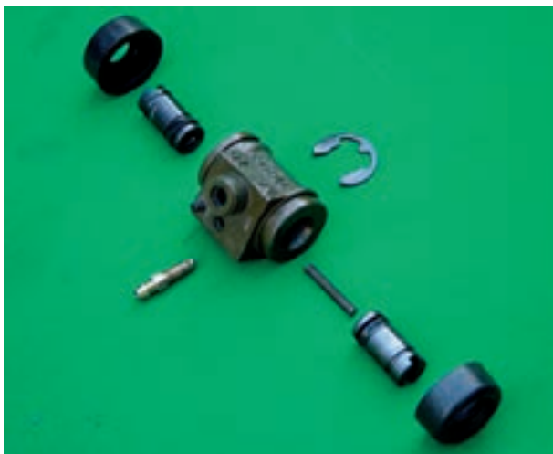
شکل ۹۵-۱- اجزای پمپ ترمز چرخ
