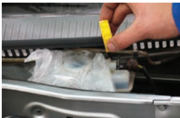
شکل ۱۳۸-۱- مسدود کردن در مخزن مایع ترمز
