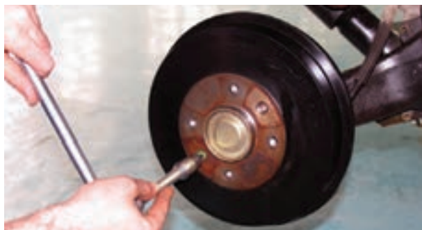
شکل ۱-۸۹ – باز کردن پیچ کاسه چرخ
