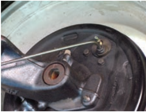
شکل ۱۰۳-۱- پاک کردن اطراف اتصالات
