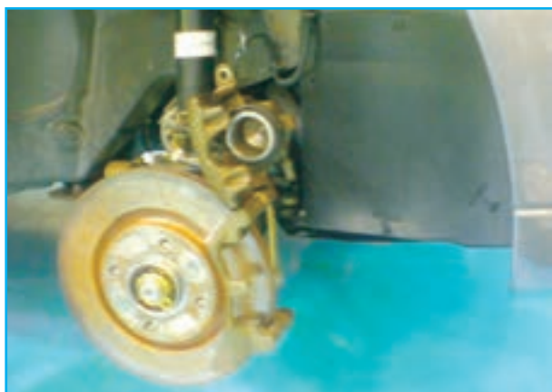
شکل ۱۱۰-۱- باز کردن پوسته نگاه‌دارنده لنت‌ها
