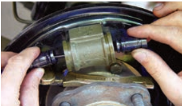
شکل ۹۴-۱- خارج کردن پیستون‌ها
