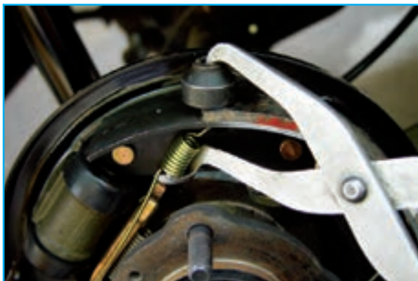
شکل ۹۱-۱- خارج کردن فنر بالایی
