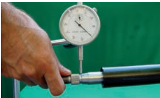
شکل ۶۹-۲- اندازه‌گیری لقی جانبی میل فرمان
