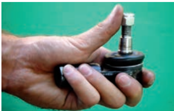
شکل ۸۴-۲- کنترل لقی سبک‌ها
