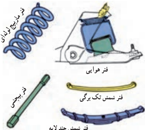
شکل ۲۴-۳ انواع فنرهای مورد استفاده در خودرو
