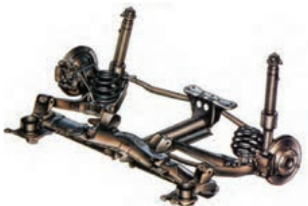
شکل ۳-۴۸- سیستم تعلیق مستقل عقب با چرخ‌های متحرک
