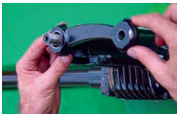
شکل ۲-۵۹- پیاده کردن اهرم هزار خار
