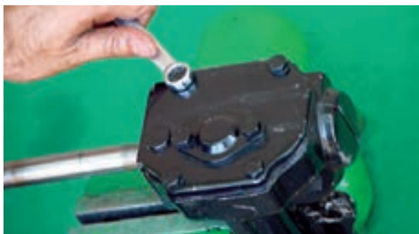
شکل ۲-۶۲- باز کردن درپوش بالایی جعبه فرمان
