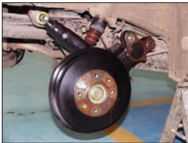
شکل ۳-۵۱- ژامبون و کمک فنر
