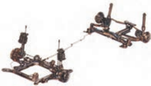
شکل ۳-۴۱- سیستم تعلیق عقب و جلو خودرو
