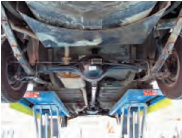
شکل ۳۱۵- دیفرانسیل در خودرو محرک عقب
