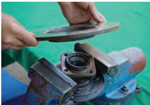
شکل ۳-۹۸- جدا کردن دیسک ترمز از تویی چرخ
