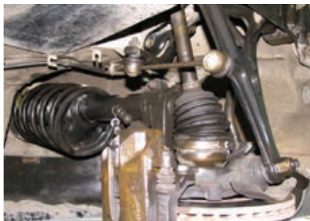
شکل ۱۳۱-۳- نصب میل موج گیر کوتاه
