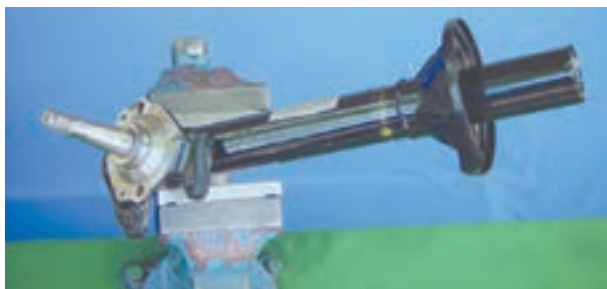
شکل ۳-۹۷- پوسته کمک فنر و محور چرخ
