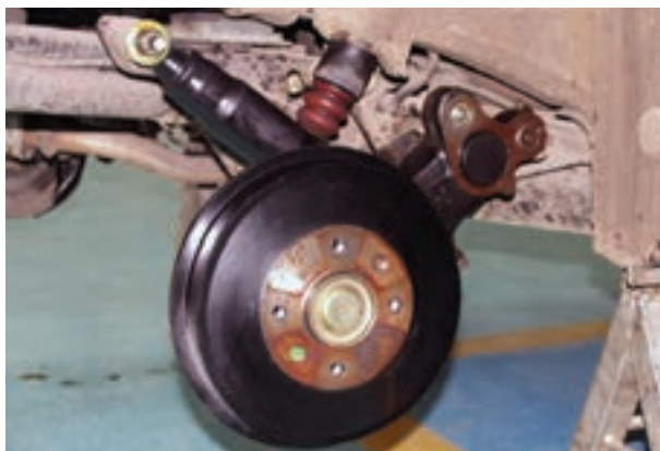
شکل ۱۷۷-۳- نصب کمک فنر
