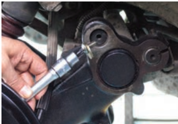
شکل ۱۷۶-۳- نصب واشر فشار و بیج‌های انتهایی میله‌ها
