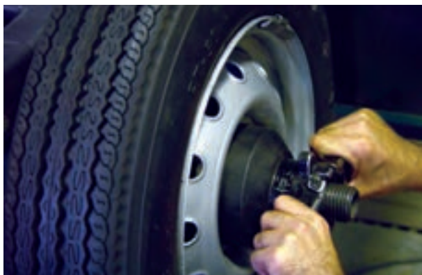
شکل ۲۳۴-۳- نصب چرخ روی دستگاه
