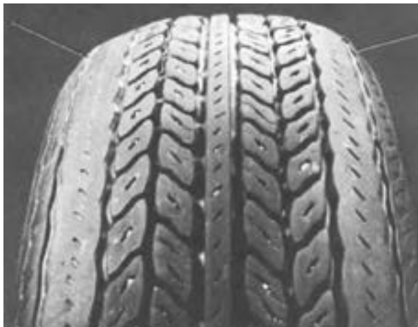
شکل ۲۱۴-۳- سایش در اثر رانندگی غلط (پیچیدن تند)
