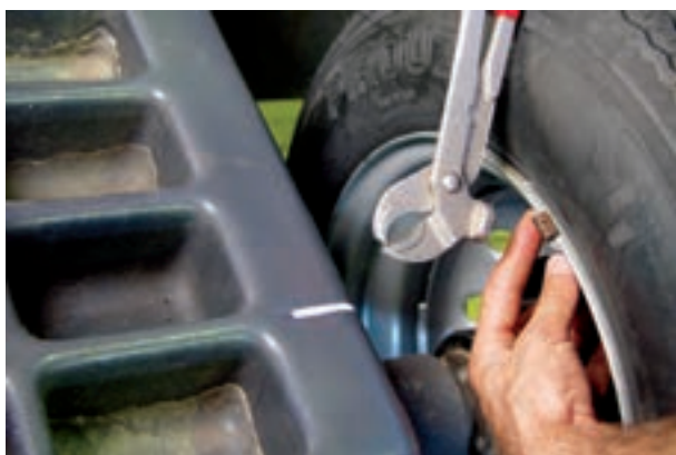
شکل ۲۳۹-۳- نصب وزنه روی قسمت داخلی رینگ
