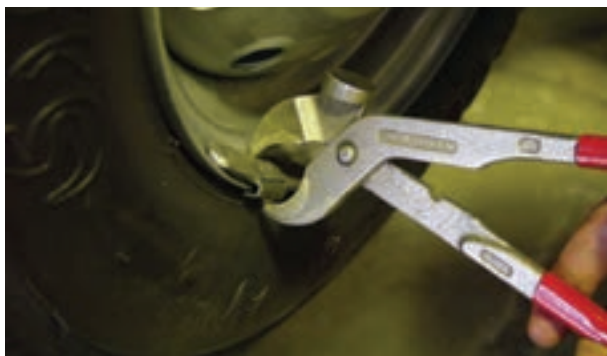
شکل ۲۳۳-۳- تمیز کردن و پیاده کردن سرب‌های قبلی
