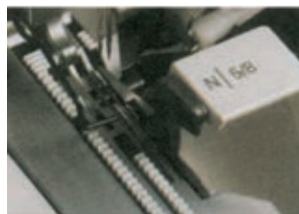
اورلوک ۲ سوزن دارد
