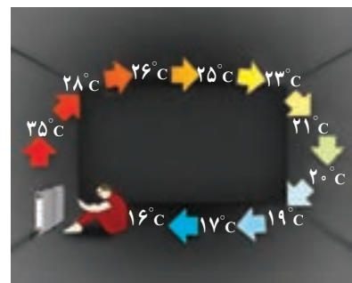
شکل ۴-۳۲ گرم شدن هوای اتاق به روش همرفت
