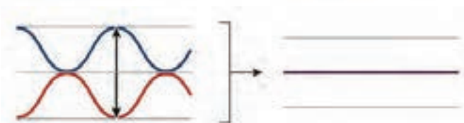
شکل ۵-۶ تأثیر امواج با فاز مخالف
