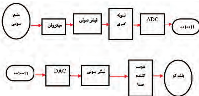
شکل ۵-۸ عملکرد ADC و DAC
