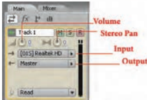
شکل ۱۰-۱۱ کنترل های ورودی و خروجی
