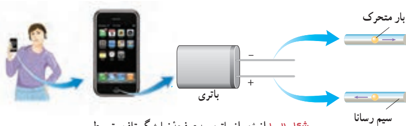
شکل ۱-۲ انرژی از باتری به صفحه نمایشگر تلفن، توسط بارهایی که از سیم‌های رسانا می‌گذرند، منتقل می‌شود.
