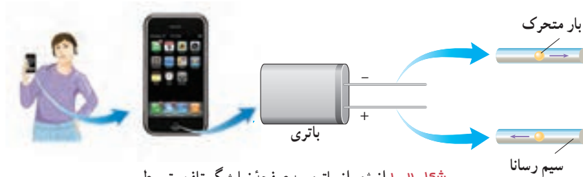
شکل ۲-۱ انرژی از باتری به صفحه نمایشگر تلفن، توسط بارهایی که از سیم‌های رسانا می‌گذرند، منتقل می‌شود.
