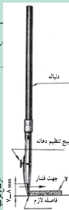
شکل ۱۶-۴ - اجزای قلم و اندازه مرکب در قلم
