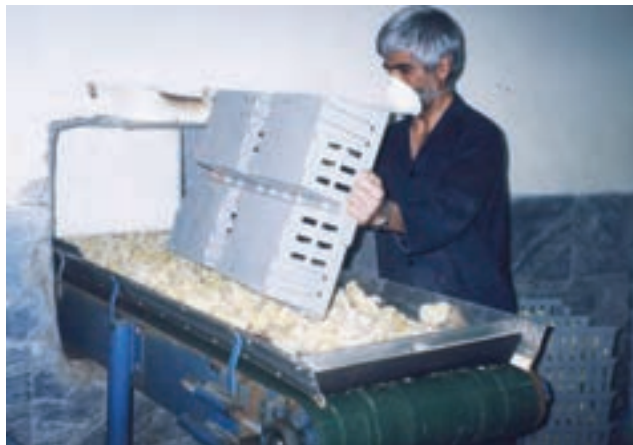
تصویر ۵-۵- تخلیه جوجه بر روی نوار نقاله
