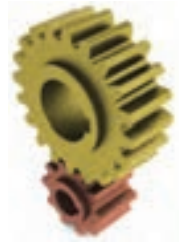
الف- ساز و کار حرکتی چرخ دنده
