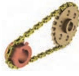
ب- ساز و کار حرکتی چرخ زنجیر
