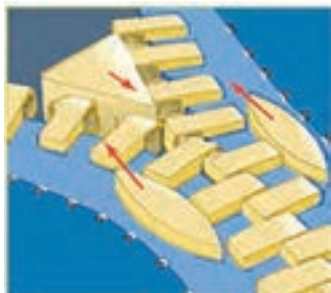
زیپ نمونه‌ای از فن‌آوری قرن بیستم است که از سه گوه بهره می‌برد. دسته زیپ از گوه‌هایی تشکیل شده که تلاش کوچک ما را به نیروی بزرگی تبدیل می‌کنند که زیپ را باز می‌کند و می‌بندد. بدون کمک این گوه‌ها، متصل کردن یا جدا کردن دندان‌های زیپ تقریباً امکان پذیر نیست.
