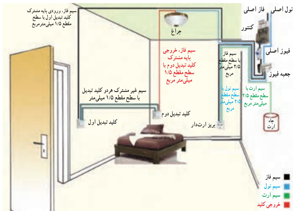
شکل ۱۸-۵ - سیم‌کشی مدار کلید تبدیل
