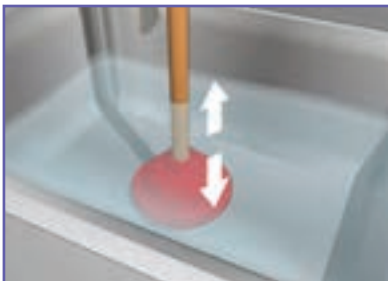
ب – حرکت عمودی لوله بازکن
