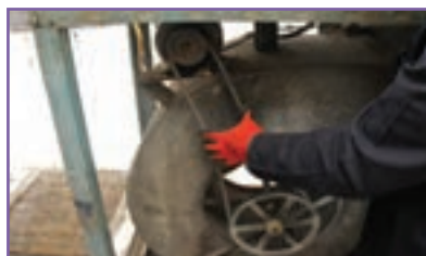
ب - بررسی وضعیت تسمه
