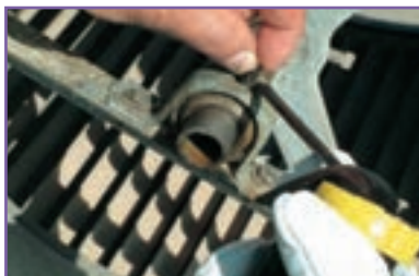
ث - روغن‌کاری یاتاقان‌ها
