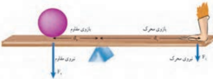
شکل ۱۱ - شکل اهرم که در آن بازوی محرک، نیروی محرک، بازوی مقاوم و نیروی مقاوم نشان داده شده است.
