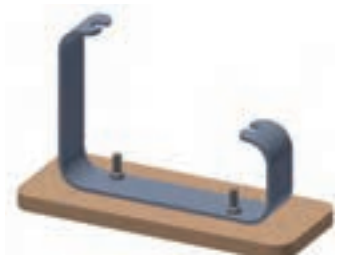
شکل ۳۹-۱- متصل کردن قطعات با پیچ و مهره
