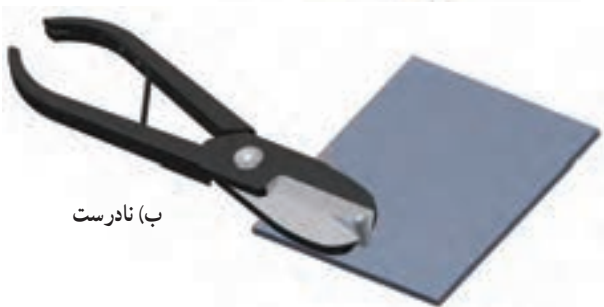
شکل ۸-۱- روش استفاده از قیچی
