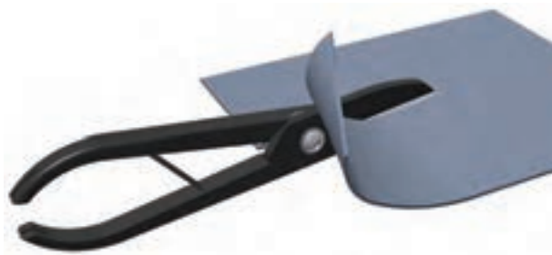
شکل ۶-۱- قیچی کاری ورق
