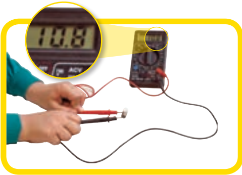
شکل ۸- اندازه‌گیری مقاومت لامپ خاموش با اهم سنج
