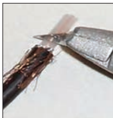
۴- عایق زیر را نیز روکش برداری کنید
