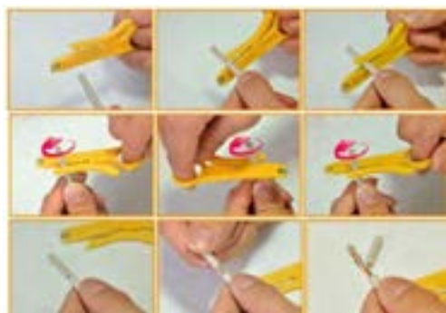
شکل ۷- روکش برداری کابل
