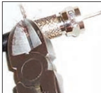
۶- بدنه فلزی و مهره ای اتصال را به ترتیب در محل‌های خود قرار داده و محکم کنید و سیم‌ها اضافی را قطع کنید.
