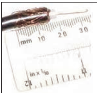
۳- یک قسمت از سیم بافته را کنار زده و عایق زیرین را از میان آن بیرون بکشید
