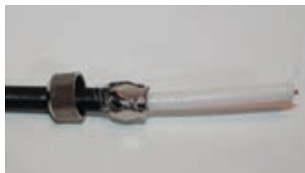
۴- برگ های گیره را مطابق شکل روی پوسته خارجی کابل جمع کنید.
