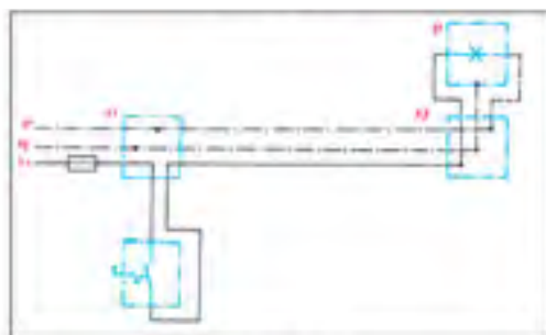
شکل ۲-۲۰- شمای حقیقی مدار کلید یک پل
