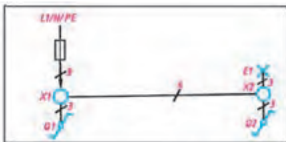
شکل ۲-۲۶- شمای فنی کلید تبدیل
