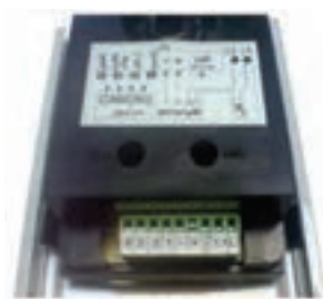
شکل ۲۵- محل تنظیم صدای بلندگو و میکروفون
