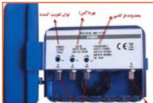
شکل ۱۵- مشخصات فنی یک بوستر یا تقویت کننده
