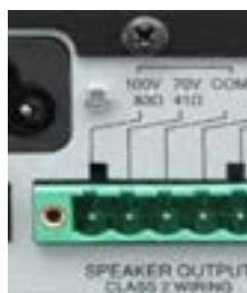
شکل ۲۳- ترمینال ولتاژ بالا
