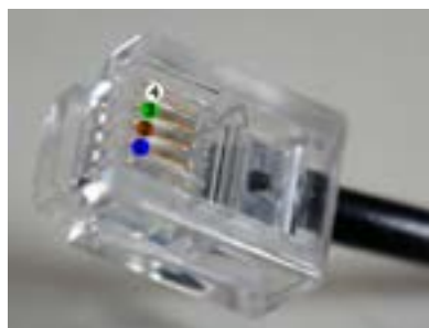
شکل ۷- فیش تلفن RJ11
