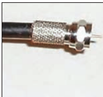
۵- اندازه مفتول مسی نباید بیش از یک و نیم سانتیمتر باشد و قسمت بافته را نیز روی پوسته خارجی پخش کنید
