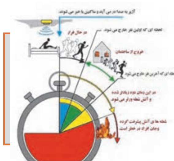
شکل ۳۰- مدیریت زمان هنگام اعلام حریق
