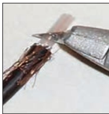
۴- عایق زیر را نیز روکش برداری کنید
