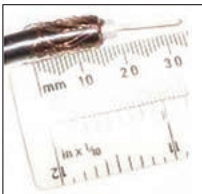
۱- به اندازه ۲ سانتی متر روکش کابل در بردارید
