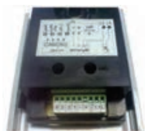
شکل ۲۵- محل تنظیم صدای بلندگو و میکروفون
