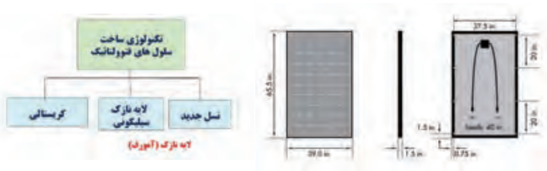
شکل ۷- ابعاد مدول خورشیدی و تکنولوژی آن
