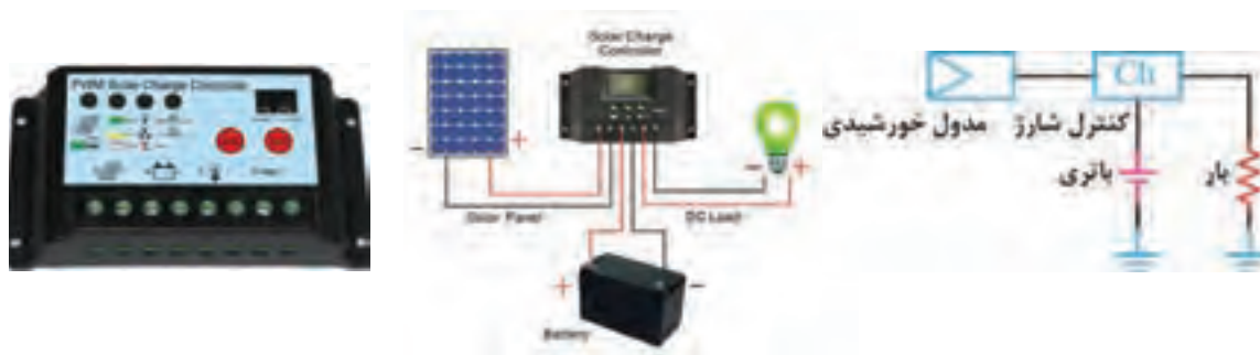
شکل ۳۳- یک نمونه کنترل کننده شارژ باتری (اتصال و شمای فنی)
