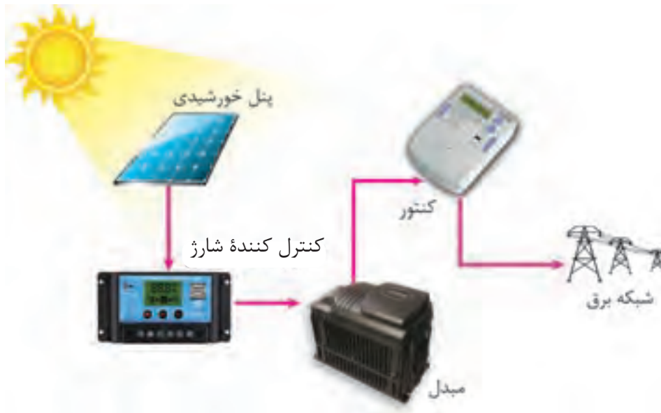
شکل ۵۱- نقشه ارتباط عناصر سیستم فتوولتایک On_Grid
