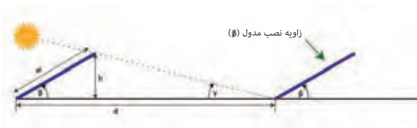
شکل ۵۴ - فاصله مجاز نصب مدول‌های خورشیدی برای جلوگیری از سایه اندازی
