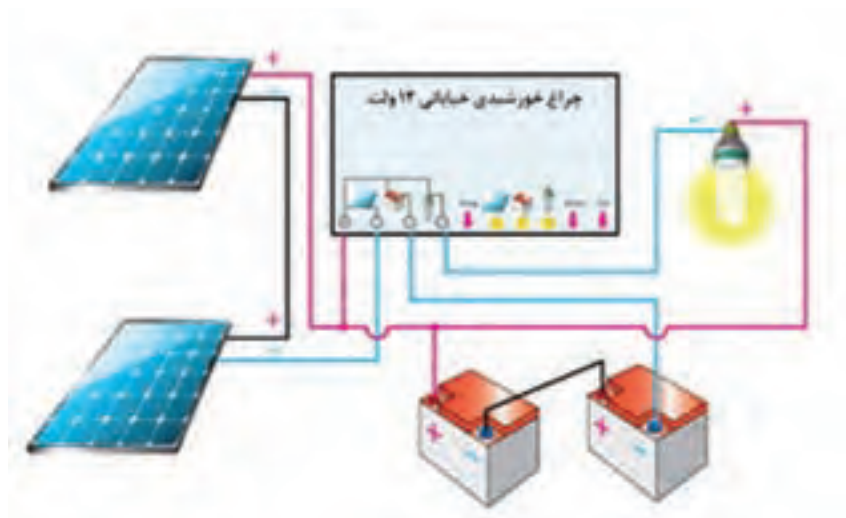
شکل ۵۲- چراغ خورشیدی خیابانی ۲۴۷ طراحی اتصال کابل
