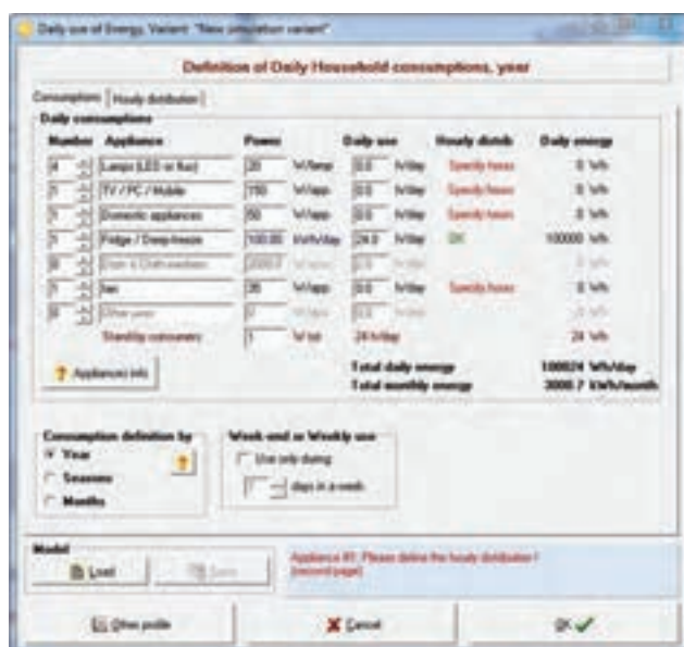
شکل ۲۱- تعیین نوع و تعداد مصرف‌کننده‌ها
