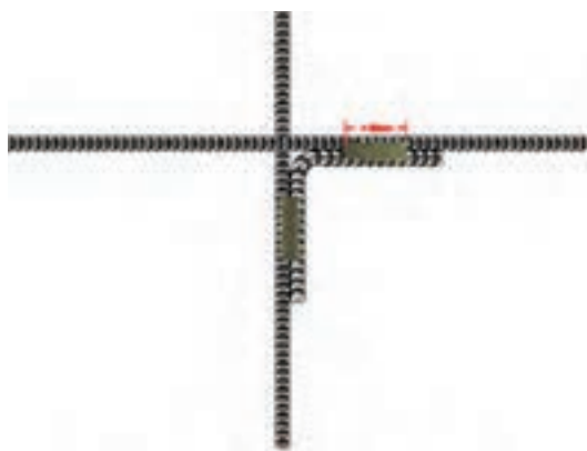
نحوه جوشکاری میلگردها در یک تقاطع چهارراه
