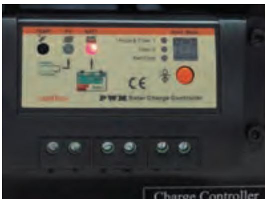
شکل ۱-۳۶ و ۲-۳۶ ال ای دی با اتصال باتری روشن می شود.
