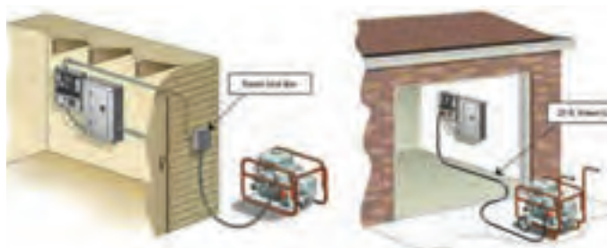
شکل ۱۲- محل اتصال موتور ژنراتور به تابلوی اصلی
