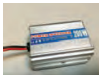
شکل ۳۹ - یک اینورتر مبدل ۱۲ ولت DC به ۲۲۰ ولت AC با توان ۲۰۰ وات و فرکانس ۵۰ هرتز
