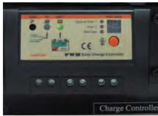
شکل ۱-۳۶ و ۲-۳۶ ال ای دی با اتصال باتری روشن می شود.
