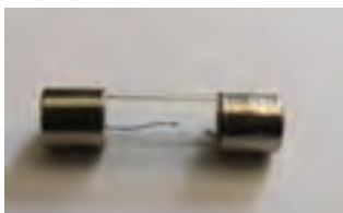
شکل ۴۹- فیوز سر راه باتری سوخته است.
