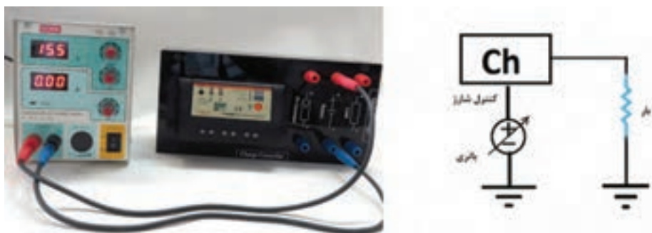
شکل ۱۹- حالت کنترل دشارژ
