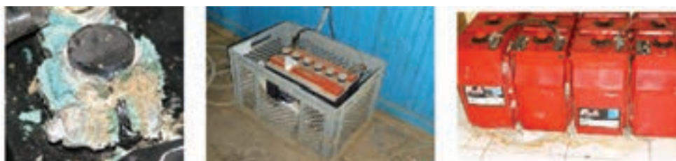
شکل ۲۱- سولفاته و نشستی باتری
