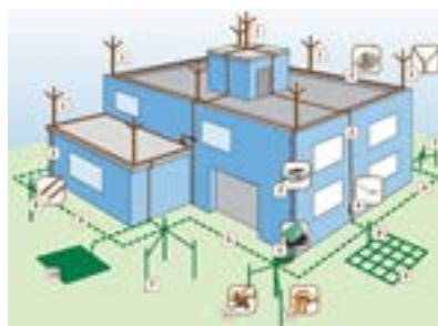
شکل ۳۸ - پراکنده کردن صاعقه در زمین
