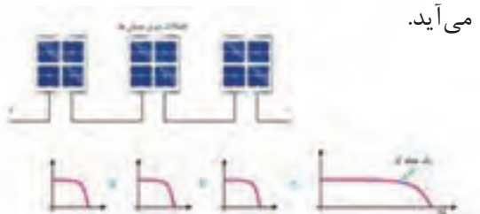
شکل ۱۲ - اتصال سری ۳ مدول خورشیدی و مشخصه نهایی با یک نقطه توان ماکزیمم
