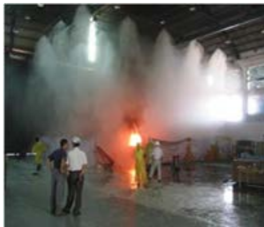
شکل ۱۱-۴: سیستم پاشش آب اطفاء حریق
