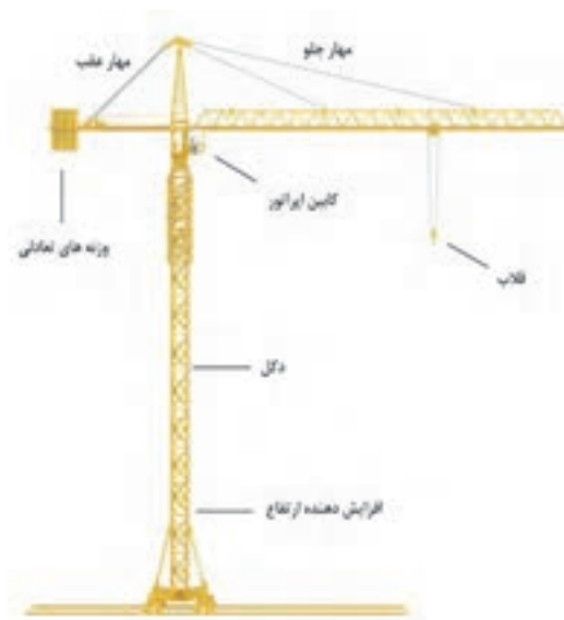
شکل ۲۲- اجزاء جرثقیل برجی (پایه ثابت)
