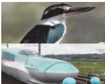
شکل ۱۰- الهام از مرغ ماهی خوار برای ساخت قطار سریع السیر
