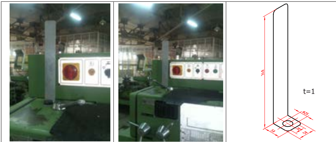
شکل ۲۱-۱- چگونگی بستن پایه نقشه
