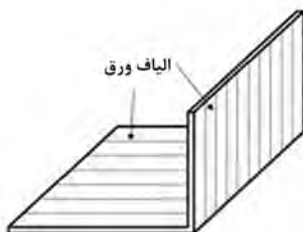
شکل ۲۹-۱- جهت الیاف ورق
