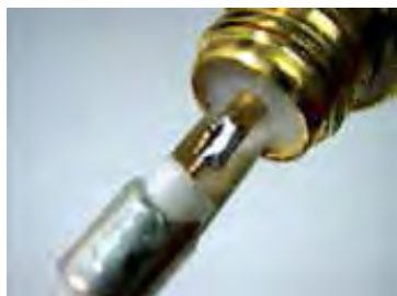
شکل ۷۰-۱- اتصال کابل کوآکسیال به فیش آنتن
