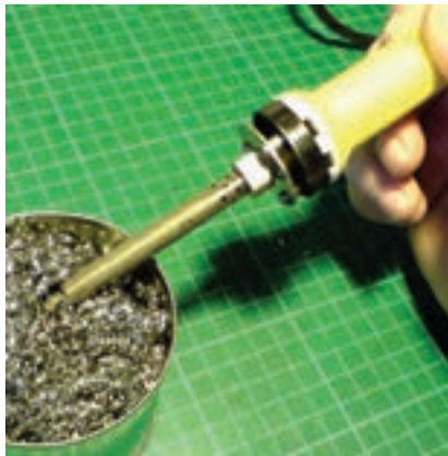
شکل ۴۲-۱- تمیز کردن نوک هویه با اسفنج مخصوص
