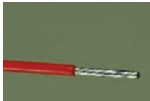
فقط قسمت بالای سیم به طور صحیح قلع اندود شده است
