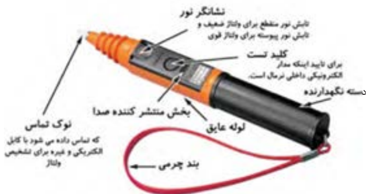
شکل ۳۸-۲- ساختمان داخلی فازمتر دیجیتالی
