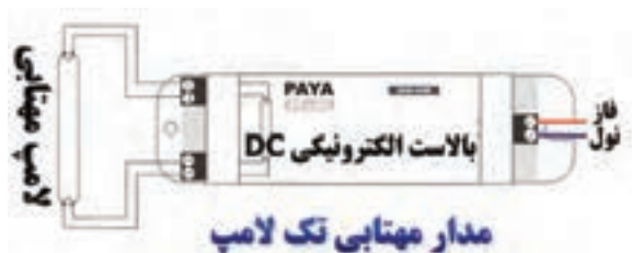
شکل ۶۱-۲- لامپ فلورسنت با انواع بالاست
