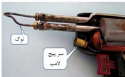
شکل ۹۶-۱ - چگونگی باز کردن هویه هفت تیری و اجزاء آن
