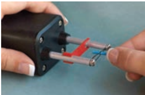
شکل ۱-۲۳ - سیم لخت‌کن ساده و حرارتی
