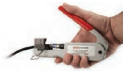
شکل ۷۲-۱ - دو نمونه دستگاه پرچ BNC
