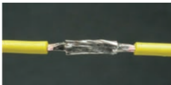
شکل ۱-۵۵- اتصال لحیم کاری کامل است.
