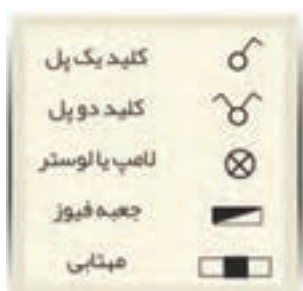
شکل ۳۰-۲- تعدادی از نمادهای فنی متداول در سیم‌کشی ساختمان
