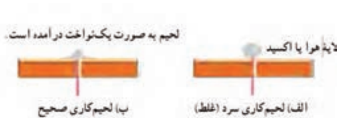
شکل ۵۰-۱- لحیم‌کاری صحیح و غلط
