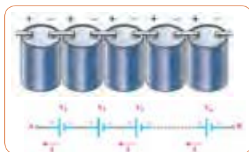
شکل ۲۴- اتصال سری پیل‌ها
