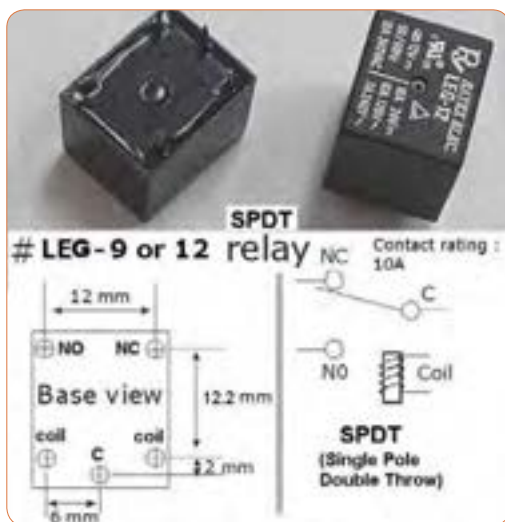
شکل ۱۱۴- مشخصات فنی یک نمونه رله
