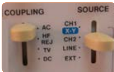
شکل ۸۸ - وضعیت‌های کلید Source
