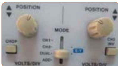
شکل ۸۲- کلید معکوس کننده فاز کانال ۲
