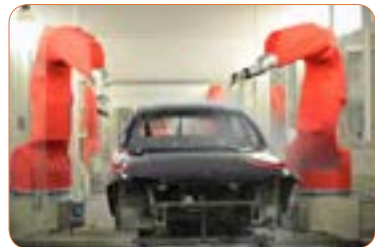
الف- دستگاه رنگ پاش الکترواستاتیکی
