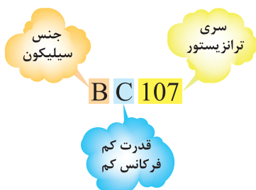
شکل ۳۱-۱۴ مشخصات ترانزیستور BC۱۰۷
