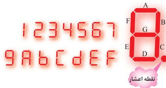
شکل ۱۳-۴۷- روشن کردن هفت قطعه ای
