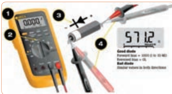
شکل ۲۷- تست دیود ناسالم و اتصال کوتاه
