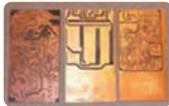
شکل ۱۱- انتقال طرح روی فیبر
