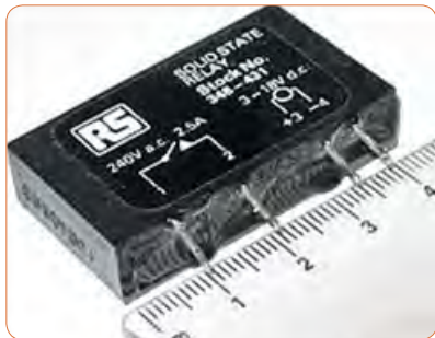
شکل ۳۵-۶ یک نوع رله حالت جامد
