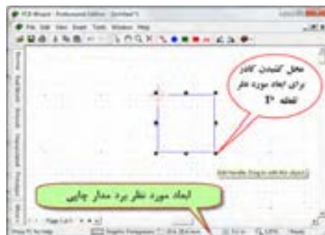
شکل ۳۸-۶- نحوه تعیین اندازه برد مدار چاپی
