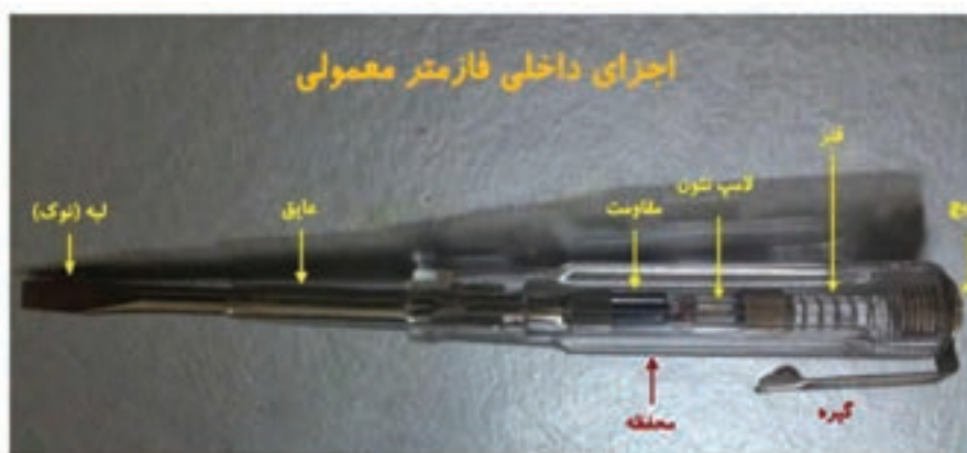
شکل ۲-۳۷- ساختمان داخلی فازمتر
