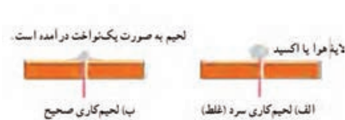
شکل ۵۰-۱- لحیم‌کاری صحیح و غلط
