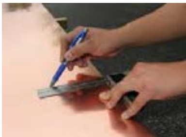
الف - تعیین اندازه فیبر
