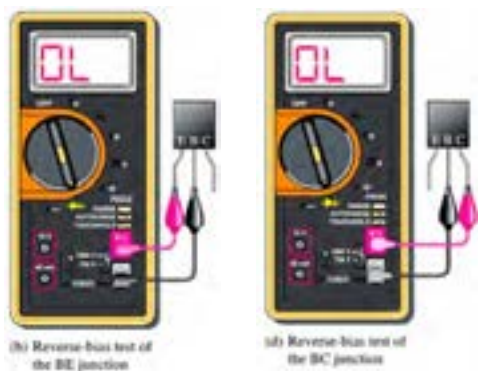
شکل ۴-۵- دیودهای بیس-امیتر و بیس-کلکتور در بایاس مخالف
