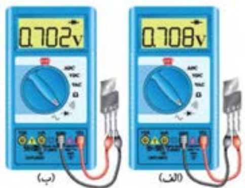
شکل ۴-۴ ولتاژ موافق کلکتور-بیس و امیتر-بیس
