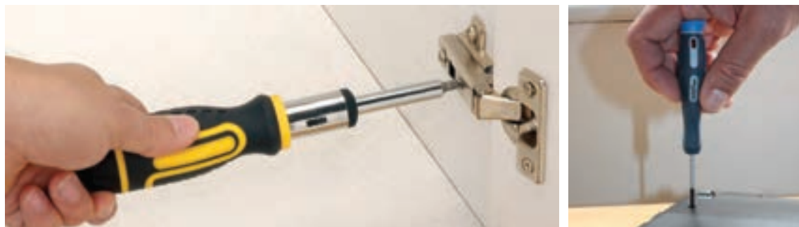
شکل ۳۱-۱- چگونگی صحیح در دست گرفتن پیچ گوشتی
