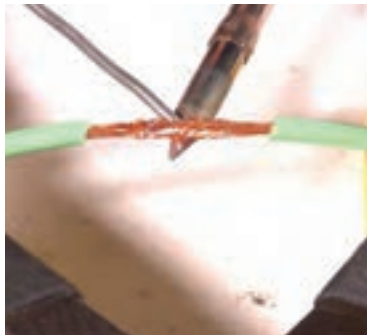
شکل ۴۹-۱- لحیم یک اتصال با سیم افشان
