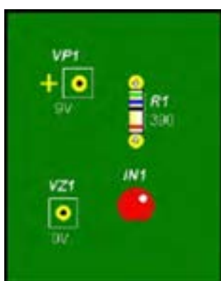
شکل ۵-۱۲- جای گذاری قطعات روی برد
