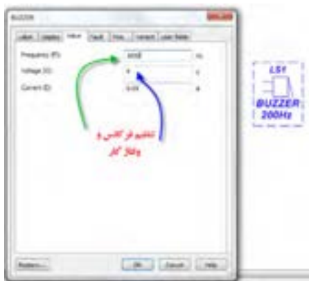
شکل ۶-۲۵- تنظیم فرکانس و ولتاژ کار بی‌زر
