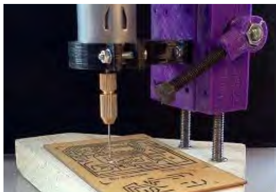
شکل ۱۸-۷- سوراخ کاری پایه قطعات با مته مناسب
