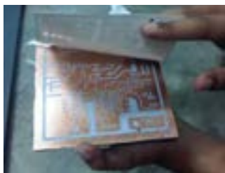
شکل ۱۱-۷- جدا کردن کاغذ از سطح روی فیبر
