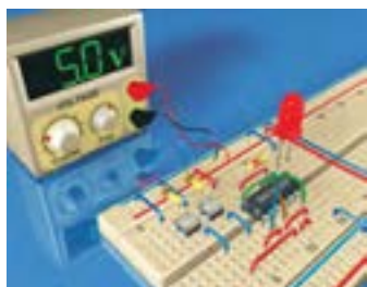
شکل ۷-۴- بستن مدار روی بردبرد و آزمایش آن
