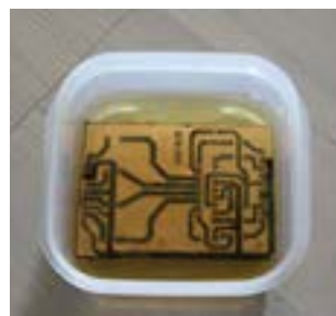
شکل ۱۴-۷- اندازه سطح محلول اسید و آب ۲میلیمتر بالاتر از فیبر
