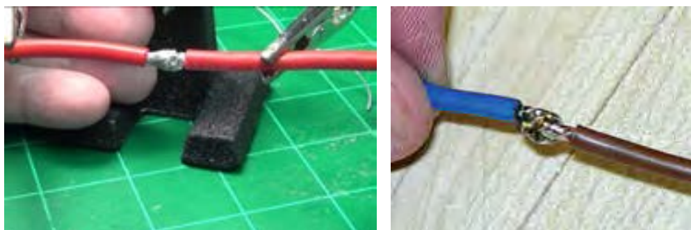
شکل ۵۳-۱ - اتصال دو رشته سیم افشان
