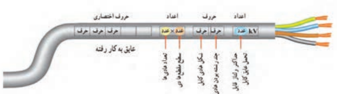
شکل ۲-۱ - مشخصات فنی یک نوع کابل
