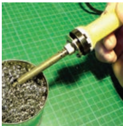
شکل ۴۲-۱- تمیز کردن نوک هویه با اسفنج مخصوص
