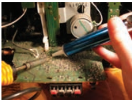
شکل ۸۴-۱ - مراحل ذوب شدن و مکش قلع
