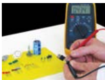
شکل ۷-۳- اطمینان از سالم بودن قطعات
