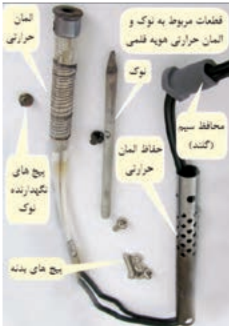
شکل ۹۵-۱ - مراقبت از اجزاء داخلی هویه قلمی
