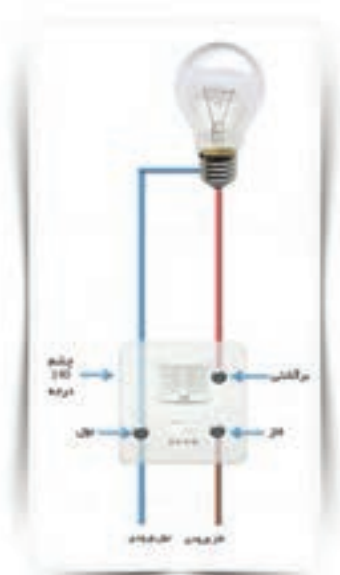
شکل ۲-۷۰- نمونه واقعی اتصال رله راه پله
