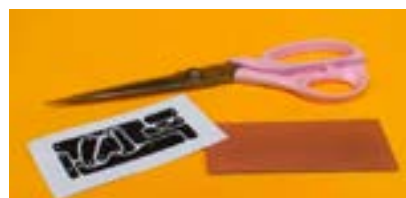
شکل ۷-۷- برش طرح مدار چاپی از کاغذ
