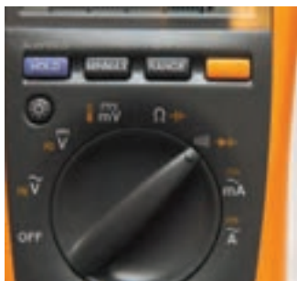
شکل ۳-۵- مولتی متر دیجیتالی در حالت آزمایش دیود
