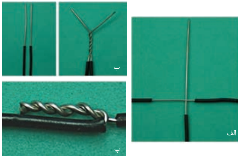
شکل ۴۸-۱- مراحل قلع اندود کردن سیم مسی
