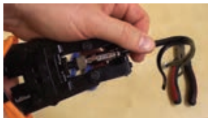
شکل ۱-۷۲ - دو نمونه دستگاه پرچ BNC
