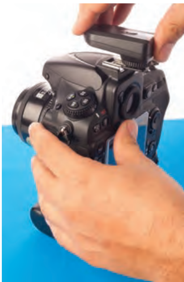
▲ اتصال ریموت فرستنده به دوربین | تصویر ۱۳۵
