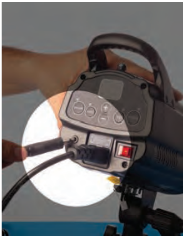
▲ اتصال سیم سینکرون رادیوتریگر به فلاش | تصویر ۱۳۶
